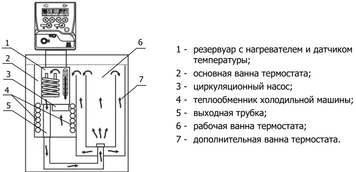
Рисунок 2 — Устройство термостата
